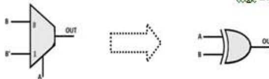
Fig. 3. Realizing XOR using 2:1 MUX
