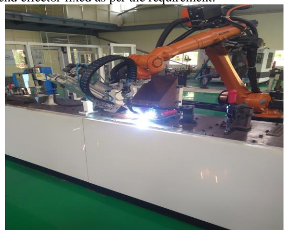
Fig. 5. MIG Welding 8-axis Kuka Robot
