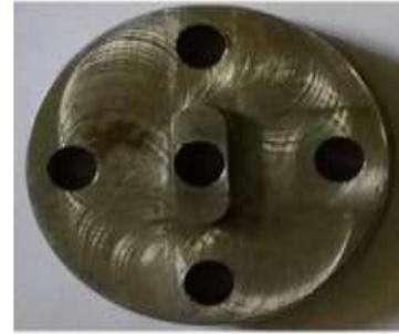
Figure 3.2 The miniature specimen holder upper die
